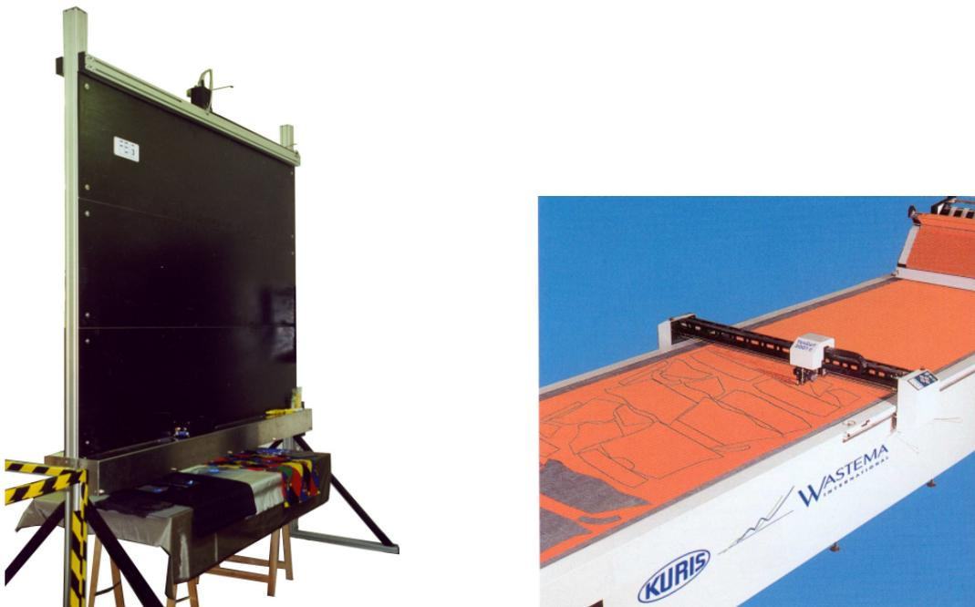
Bild 5-1: Der Prototyp der Fehlererkennung (links) und der Einzellagenzuschnittautomat in Serienausführung (Kuris-Wastema 2000)
